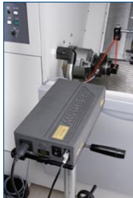
L'interférométrie laser figure au rang des méthodes les plus précises. Avec son laser homodyne ML10 Gold, Renishaw garantit une incertitude de mesure de l'ordre de 0,7 micromètre à 1 mètre.
