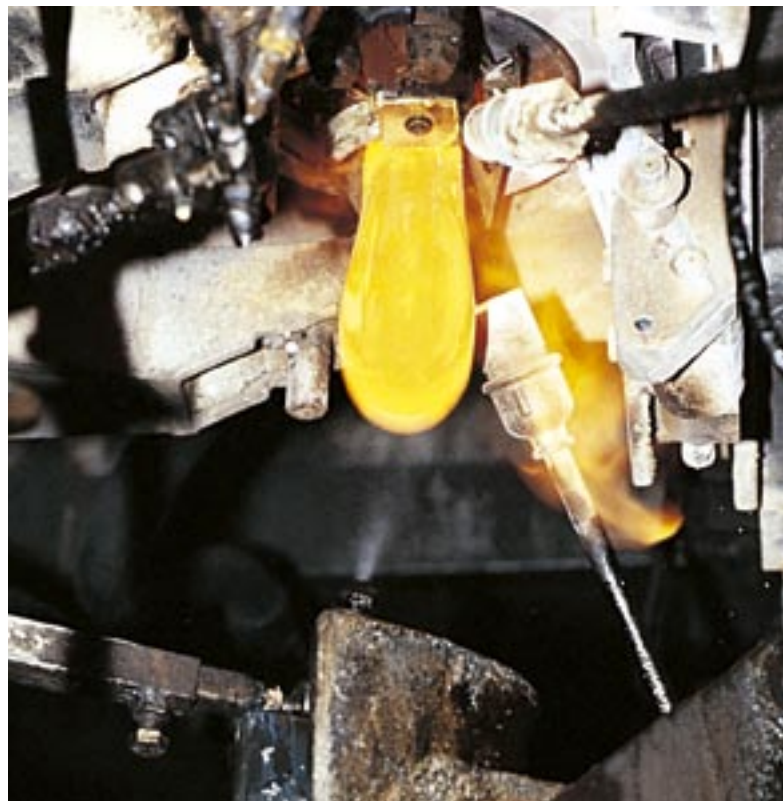
Produit dans les fours, le verre est acheminé vers les machines de formage via un canal de distribution (feeder) au bout duquel se constitue une goutte de verre dont la température doit être ajustée précisément selon le type de pièces à réaliser.
