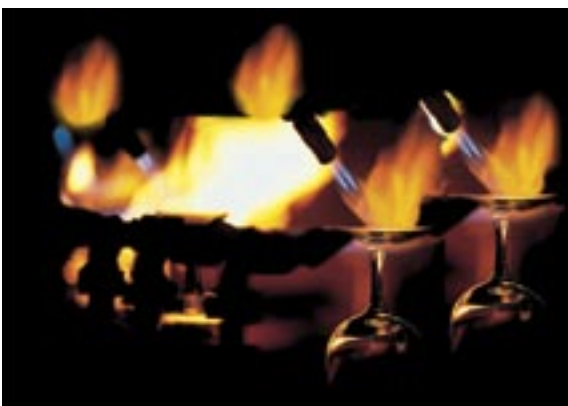
Produit dans les fours, le verre est acheminé vers les machines de formage via un canal de distribution (feeder) au bout duquel se constitue une goutte de verre dont la température doit être ajustée précisément selon le type de pièces à réaliser.
