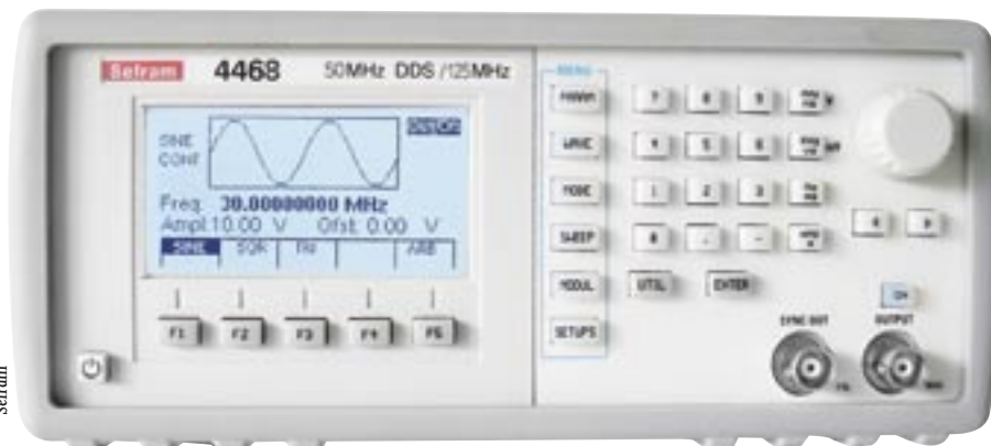
La plupart des générateurs de signaux arbitraires offrent toutes les fonctionnalités d'un générateur de fonctions traditionnelles (sinus, carré, triangle, rampe, etc.) auxquelles s'ajoutent des capacités de modulations (AM, FM, FSK). Il est également possible de synchroniser plusieurs instruments pour obtenir des formes d'ondes complexes.
