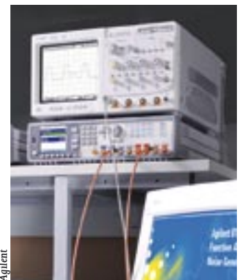
Le générateur de signaux arbitraires récupère des valeurs numériques dans sa mémoire pour les convertir en signaux analogiques.
