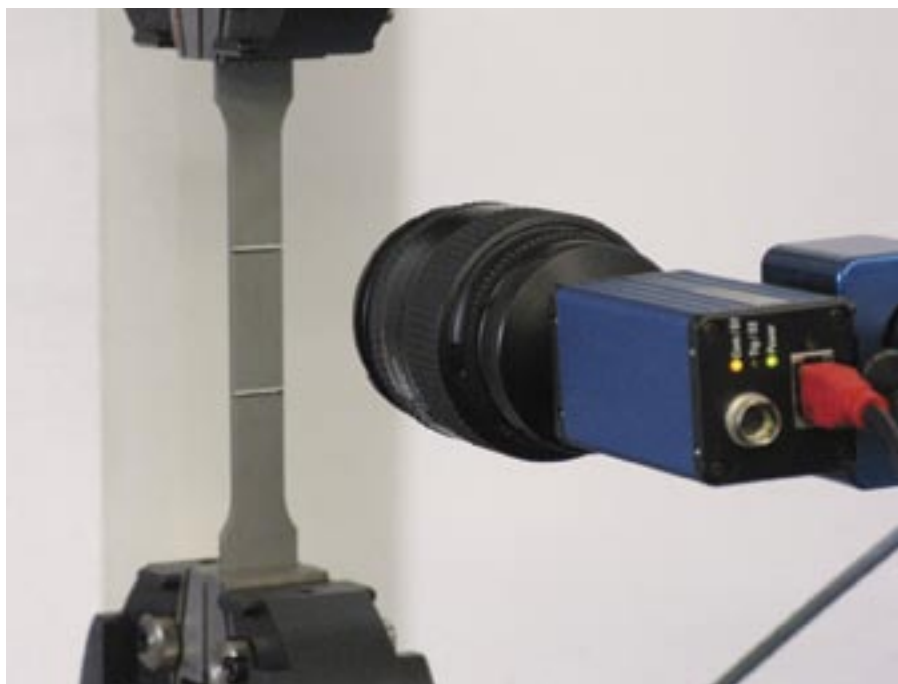
En associant une caméra numérique à un logiciel de traitement d'images, on réalise un extensomètre optique. Ce montage est utilisé pour visualiser et mesurer les déplacements 2D.
