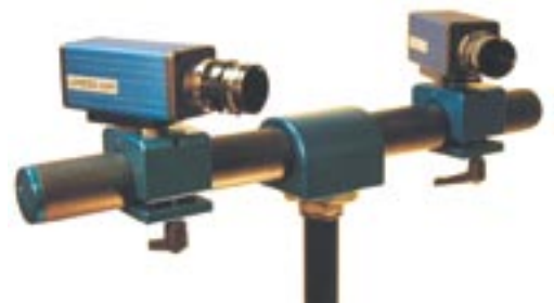
La corrélation d'images requiert un matériel simple : deux caméras numériques et un logiciel d'analyse suffisent.
