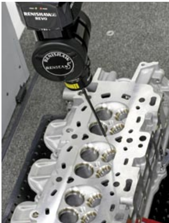
Le rétrofit englobe un grand nombre d'opérations nécessaires à la rénovation d'une MMT. S'il se limite souvent à installer une simple mise à jour logicielle, il peut aussi consister à remplacer le système de palpage.
