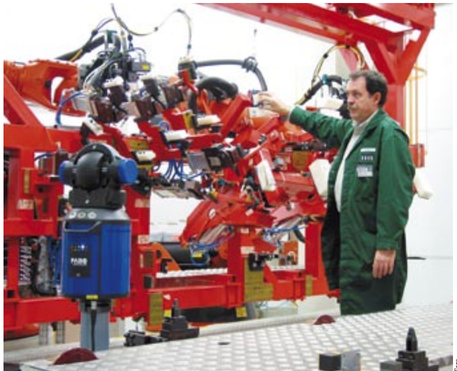
Dans de nombreuses applications de mesure 3D, le laser de poursuite fonctionne de manière autonome, sans autre moyen de contrôle. Mais il faut tout de même lui associer un réflecteur. Pour cela, il suffit de déplacer une petite sphère métallique à la surface de la pièce que l'on souhaite contrôler.
