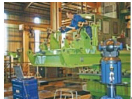
Les bras de mesure peuvent être utilisés seuls ou associés à un laser de poursuite. Dans ce cas, le laser ne doit pas forcément "voir" le bras durant le contrôle.
