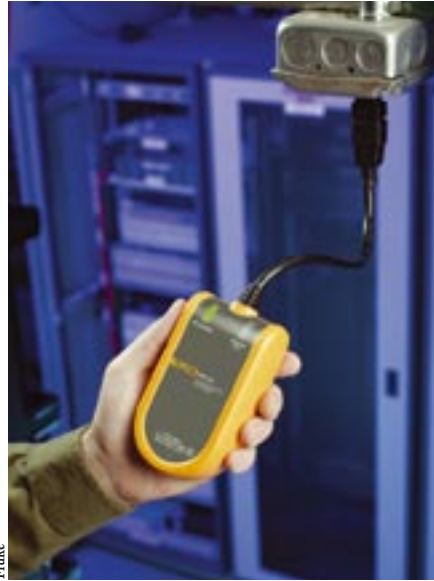
Le VR 1710 de Fluke effectue des enregistrements en continu. Toutes les données sur la tension et les différents événements sont mémorisés par l'instrument.
