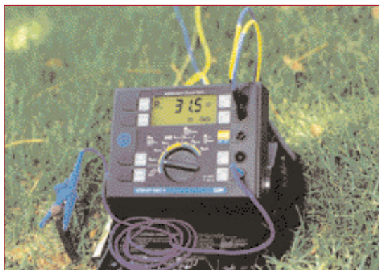
Le moindre défaut dans un dispositif de mise à la terre peut avoir des conséquences dramatiques sur les personnes et les biens. Pour éviter cela, il existe différentes méthodes pour contrôler et mesurer résistivité des sols et résistances de terre... en fonction du type de mesure et de la place disponible.
