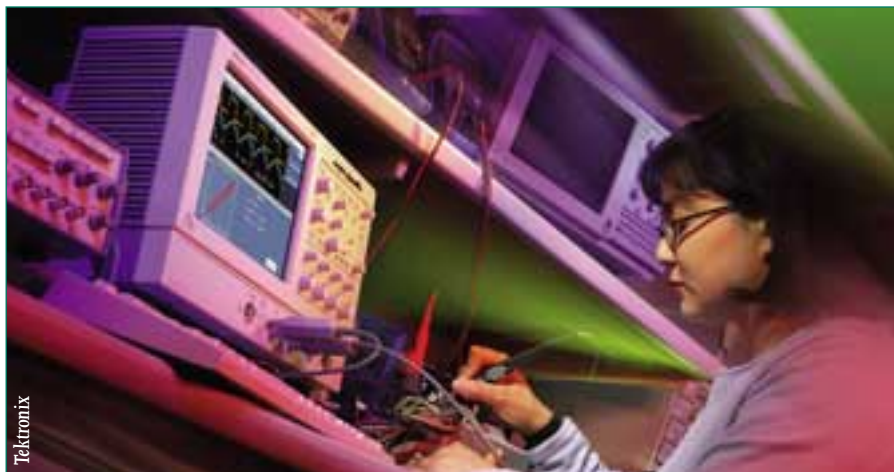
L'oscilloscope est l'outil le mieux adapté pour visualiser des signaux électriques en temps réel. Les modèles à mémoire numérique permettent de stocker les données, simulent les écrans des oscilloscopes analogiques et deviennent de véritables centres d'informations.
