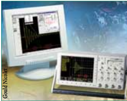
Il existe deux sortes d'utilisateurs d'oscilloscopes numériques : les traditionnels qui ne jurent que par les boutons rotatifs et ceux qui ne peuvent plus se passer d'un clavier, d'une souris et d'un écran de PC. C'est pourquoi les oscilloscopes proposent les deux interfaces en standard.
