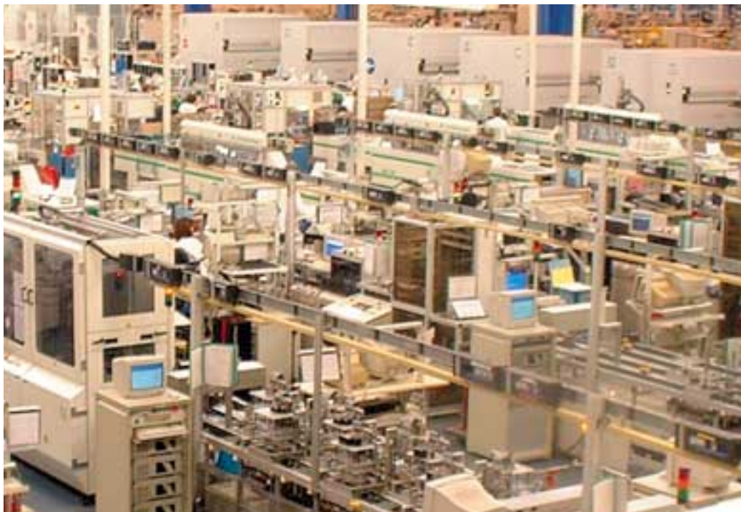
Dans l'industrie automobile, les tolérances sur les pièces défectueuses sont très serrées. Pour les "tenir", SiemensVDO pratique des tests sur l'intégralité des matériels fabriqués, le plus en amont possible de la chaîne d'assemblage.
