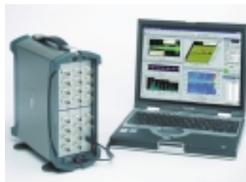
Les analyseurs permettent de définir un certain profil d'essai, et de suivre le comportement de l'échantillon en fonction de la sollicitation qui lui est appliquée.
