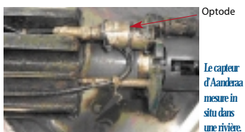
Aqualyse a intégré un capteur optique d'O 2 dans une sonde multi-paramètre qui mesure aussi la température, la conductivité, le pH, le redox, le niveau, la salinité, la turbidité, l'ammonium, les nitrates, les chlorures... Il peut être immergé jusqu'à 250 mètres de profondeur.
