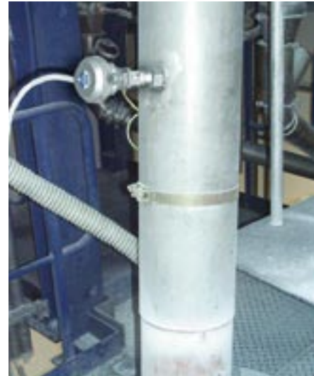
Le principe basé sur la tribo-électricité a fait ses preuves pour les mesures en process ou à l'émission. Autres arguments, son prix et sa facilité de montage
