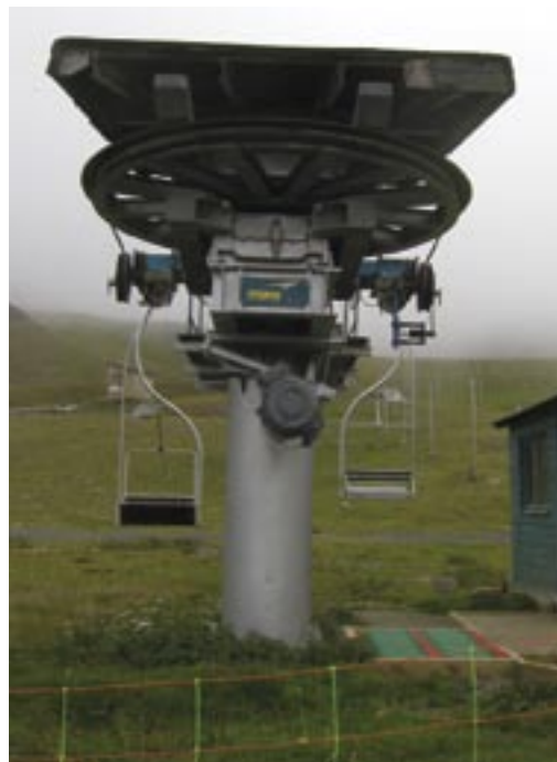
Les remontées mécaniques sont également toutes équipées de motorisations à courant continu. Plus que de la puissance, on recherche ici un couple pour faire monter les skieurs aux sommets des pistes.
