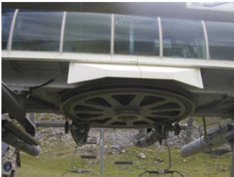
Les remontées mécaniques sont également toutes équipées de motorisations à courant continu. Plus que de la puissance, on recherche ici un couple pour faire monter les skieurs aux sommets des pistes.
