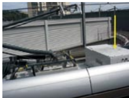
... c'est pourquoi Alstom a conçu un système d'alimentation spécifique. Des batteries sont placées sur le toit des rames.
