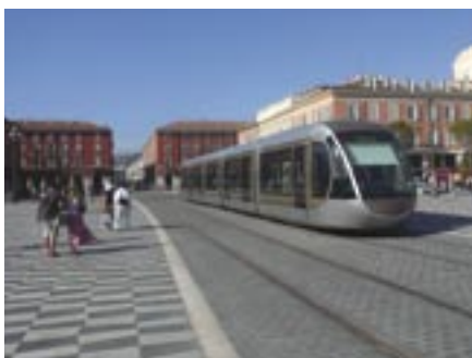
L'usage de pantographes a été proscrit pour les tronçons de la ligne qui traversent des lieux touristiques...
