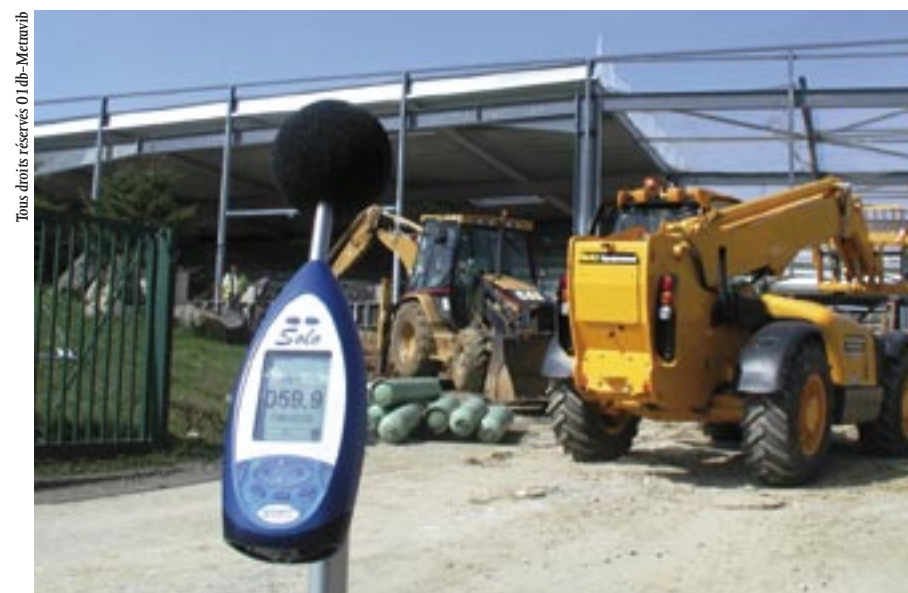
Certains fabricants ont développé des instruments spécialement adaptés à des applications précises (bâtiment, bruit au travail, environnement... qui mesurent ou calculent les grandeurs les plus représentatives de la situation.
