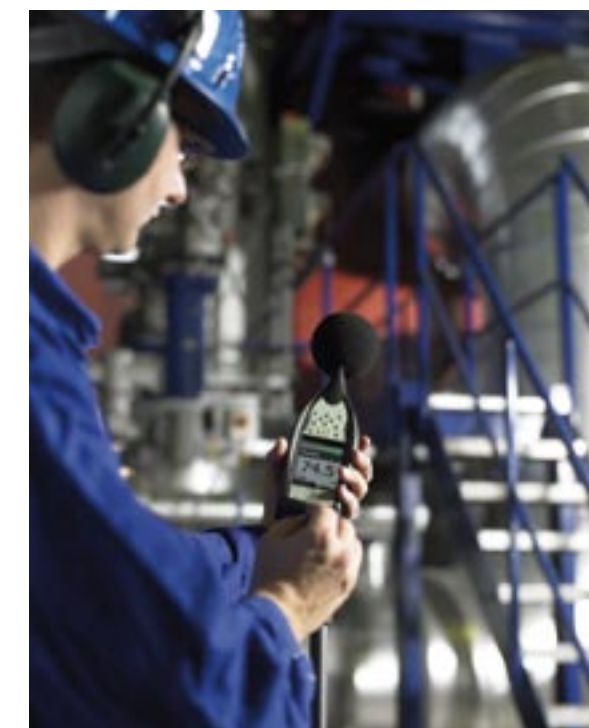
L'ergonomie est aujourd'hui au cœur des préoccupations des fabricants. Sur plusieurs modèles disponibles sur le marché, l'utilisateur peut ainsi marquer des événements directement sur l'écran du sonomètre avec un stylet.
