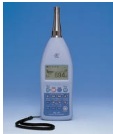
Les sonomètres intégrateurs/moyenneurs calculent des niveaux de bruit équivalents. Plus sophistiqués que les conventionnels, ils caractérisent plus finement le bruit.
