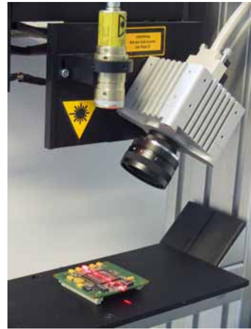
On peut réaliser une application de triangulation en choisissant le laser et la caméra 3D. Certains modèles intègrent le capteur d'images et un FPGA qui réalise une grande partie du traitement.
