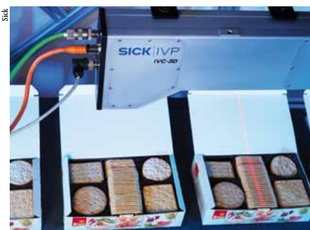
Dans le domaine de la triangulation laser, il existe des systèmes prêts à l'emploi intégrant le capteur, le laser, et même le traitement des données 3D. Ces solutions peuvent délivrer des informations TOR, comme un caméra 2D intelligente.
