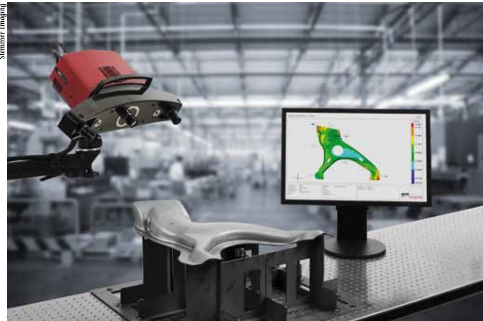
Dans le domaine de la stéréovision, comme en triangulation laser, il existe aussi des solutions déjà précalibrées, pour faciliter la tâche de l'utilisateur final. Les systèmes de Gom, par exemple, intègrent les caméras dans le même boîtier. Ils réalisent un contrôle 3D suivant un principe proche de la vision humaine.
